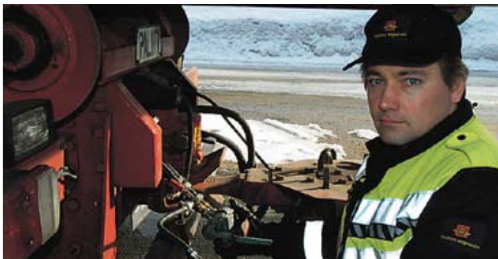
Bremsejekk: Ulf Jørgen Wold kobler teknisk måleutstyr på bilens bremsesystem.
