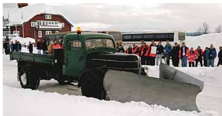
Tung brøytebil i 1951: Volvo Titan med 105-hesters bensinmotor og totalvekt på 5,6 tonn.
