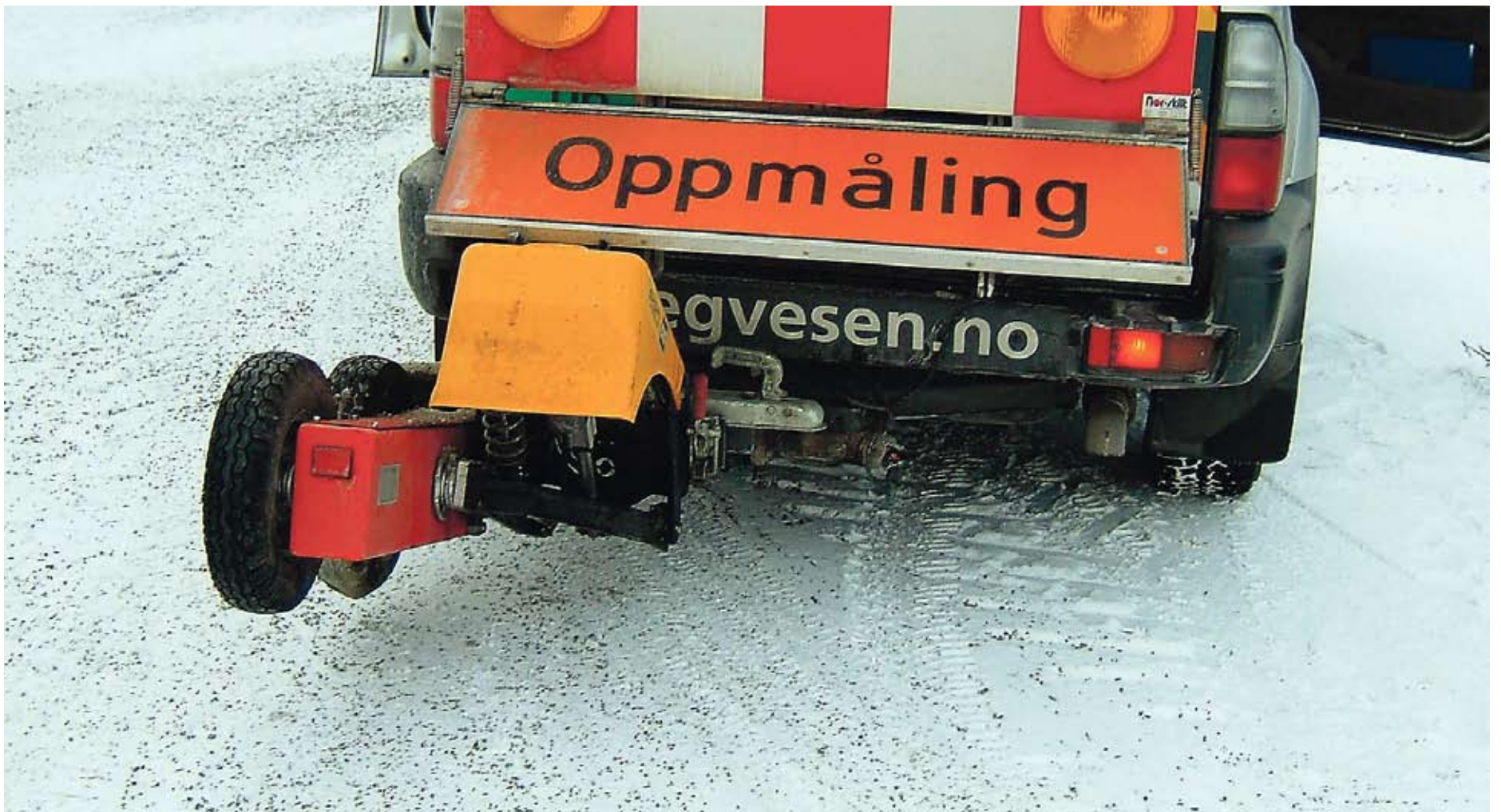
Måler friksjon: Sist vinter ble det kjørt nærmere 200 turer opp og ned Romsdalen med friksjonsmålebilen. (Foto: Reidun Øverland)
