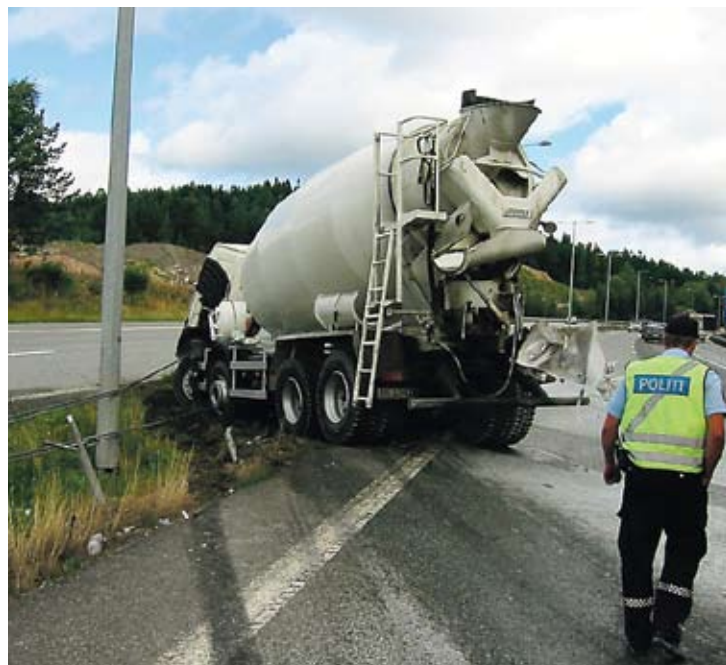
Sikring: Fagforeningen NITOs enhet i Statens vegvesen vil ha tilbake wirerekkverk på norske veger. Her har et wirerekkverk stanset en betongbil i Lierbakkene på E18. (Arkivfoto: Hans Storm Magnussen)
