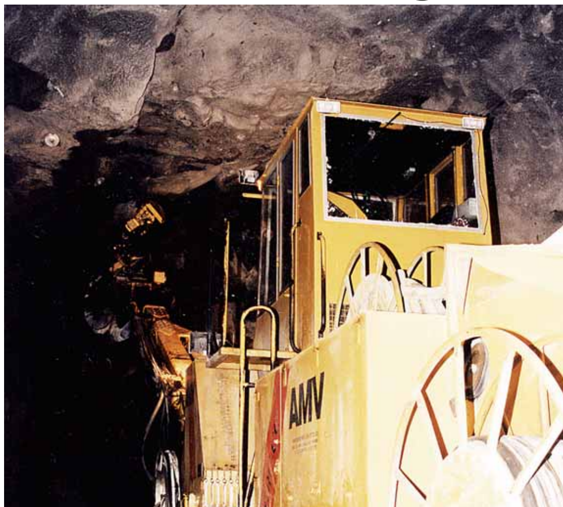
Sjablonsikring: Prosedyren kan føre til at store områder med fjell blir oversikret, mens mer rasfarlige områder kan bli undersikret eller ikke oppdaget. (Arkivfoto: Erling Grønsdal)
