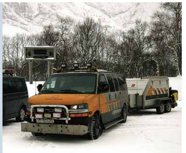
Måler friksjon: Utstyret bak denne bilen måler friksjonen på vegen i Romsdalen. (Foto: Reidun Øverland)
