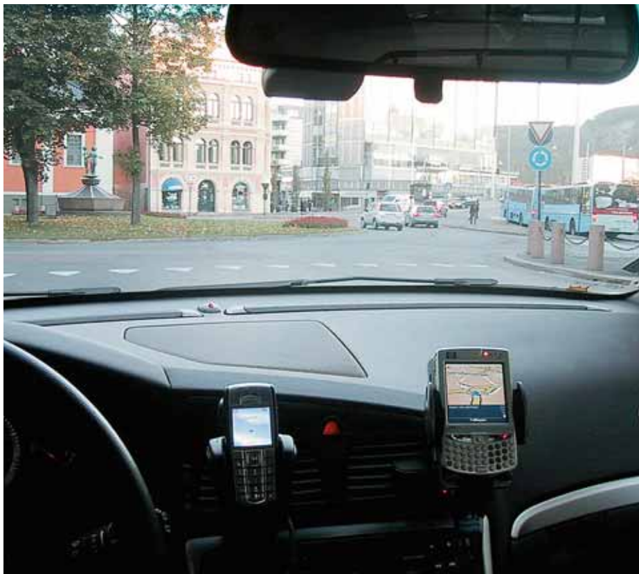
Riktig: Slik bør GPS-utstyret monteres, på dashbordet uten sikthinder til frontvindu. (Foto: Tore Braaten)
