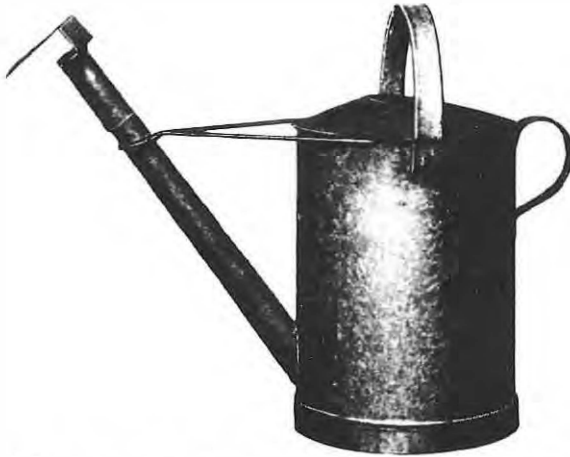
Fig. 3. Galvanisert kanne til utlegning av Koldmex. (Norsk fabrikat). Tuten har en plate, som sprer emulsjonen.
