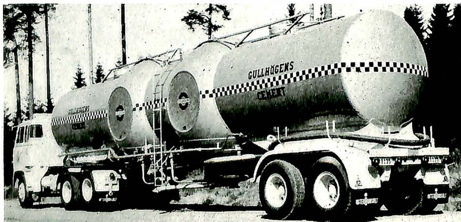
Fig. 1. Combivognen med sfæriske sylindre for cement og andre pulverformige materialer. De sylindriske tankene er beregnet for olje.
