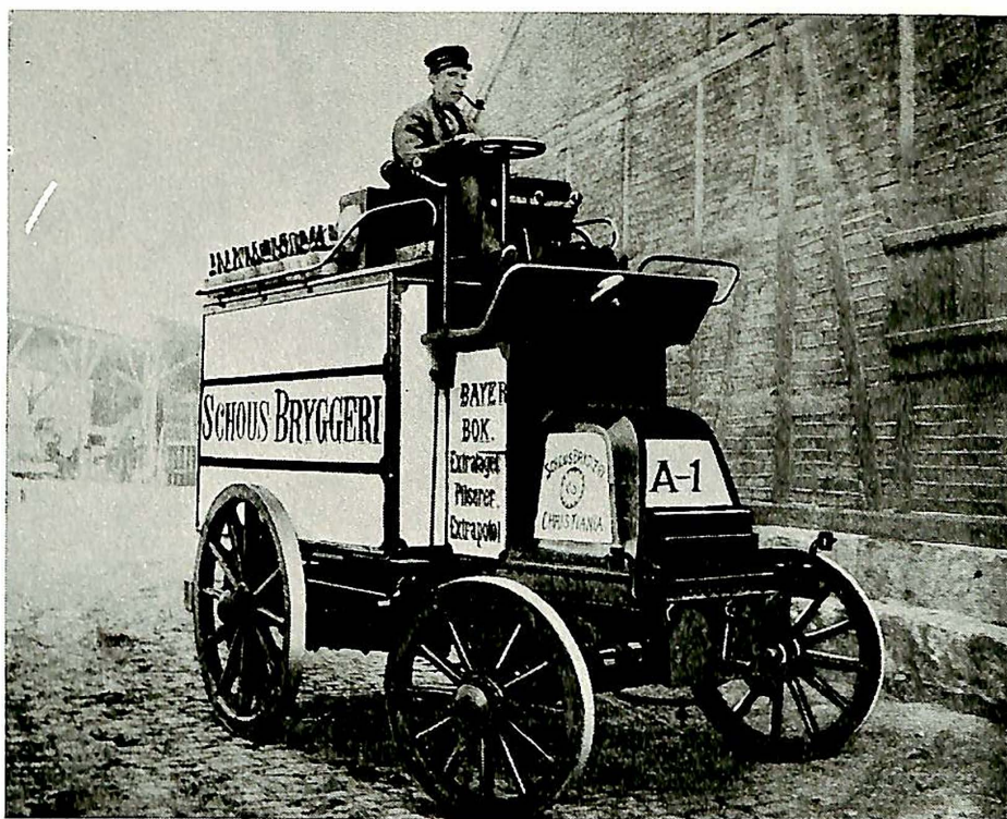
Fig. 3. Norges første lastebil, en Daimler fra 1900. Tophastigheten var 15 km/t.
