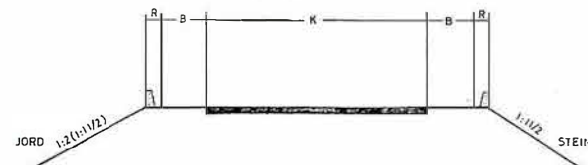
Fig. 2. Grunnprofilen for vegklasse IIa og IIb i skjæringer og fyllinger. Dype sidegrøfter nyttes hvor bærelaget ikke overstiger 0,75 m. På fyllingsprofilene angir K kjørebanebredde, B bånkettbredde og R rekkverkrom. I normalt terreng er verdiene for K for de to vegklassene henholdsvis 7,5 og 7,0 m, for B henholdsvis 3,0 og 1,5 m mens R er 0,5 m for begge vegklassene. I kostbart terreng kan bånkettbredden reduseres med 50 %, dvs. B er henholdsvis 1,5 og 0,75 m.
