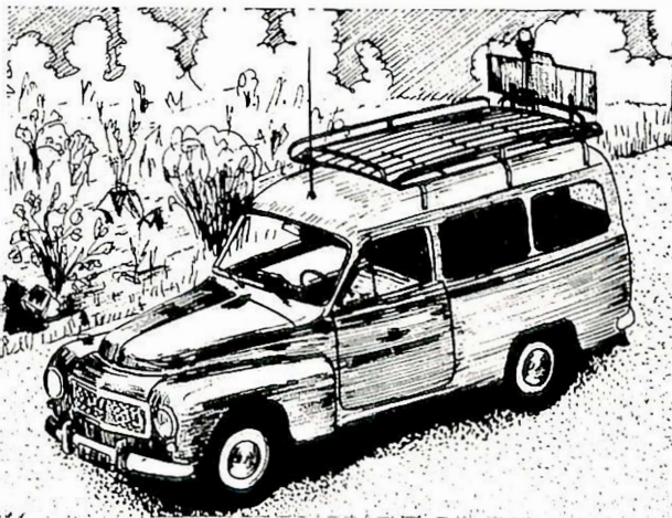
Fig. 1. Spesialutstyrt bil for vegelementregistrering.
