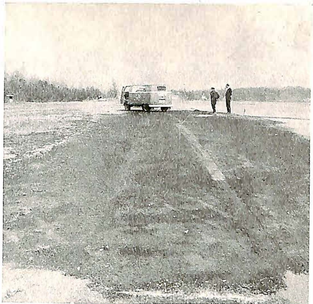
Fig. 3. Fire nedslitte dekk. Våt grus, hastighet 70 km/h.
