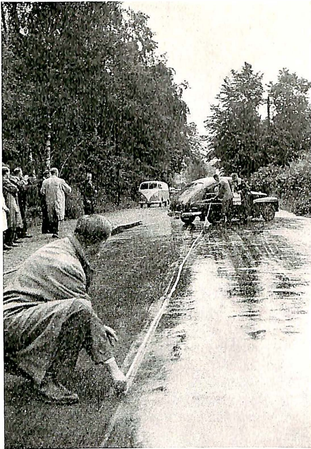
Fig. 4. Nedslitte, usnittede dekk. Våt asfalt, hastighet 50 km/h.
