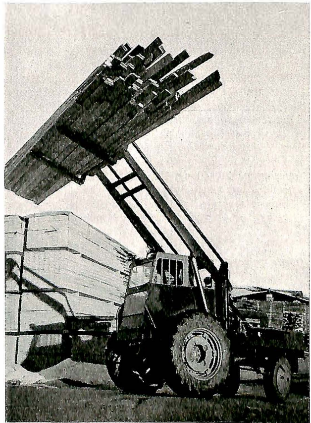
Fig. 6. Gå ikke under hengende eller løftet last. Er traktorfører for rask på clutchen, kan lasset tippe over.
