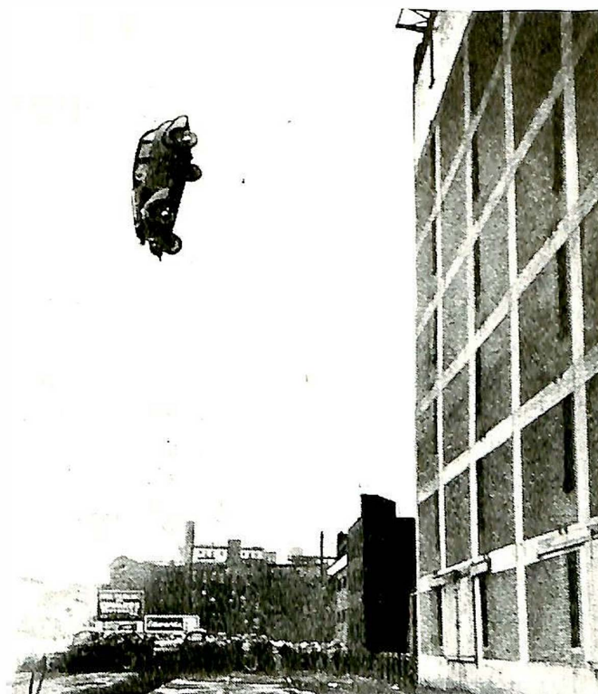
Fig. 3. Ved påkjørsel af et træ eller annen fast genstand med en fart af 80 km/h sker det samme som når denne bil når jorden fra ca 25 m højde.
