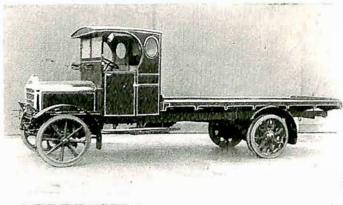
Fig. 2. Engelsk Daimler, 2—3 tonns chassis, type CT 22, modell 1920.
