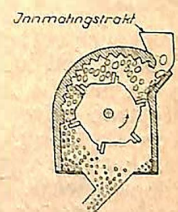
Fig. 4. Slagknuser med faste hammere
