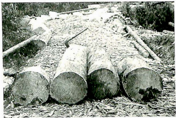
Ca. 50 år gammelt tømmer fra Svarva bro i Snåsa.
