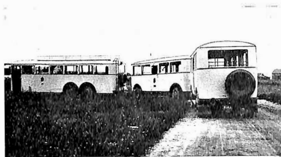
Fig. 3. Tidaholms 3-akslede boggiomnibus med selvsporende tilhengervogner for persontrafikk i en skarp kurve.
