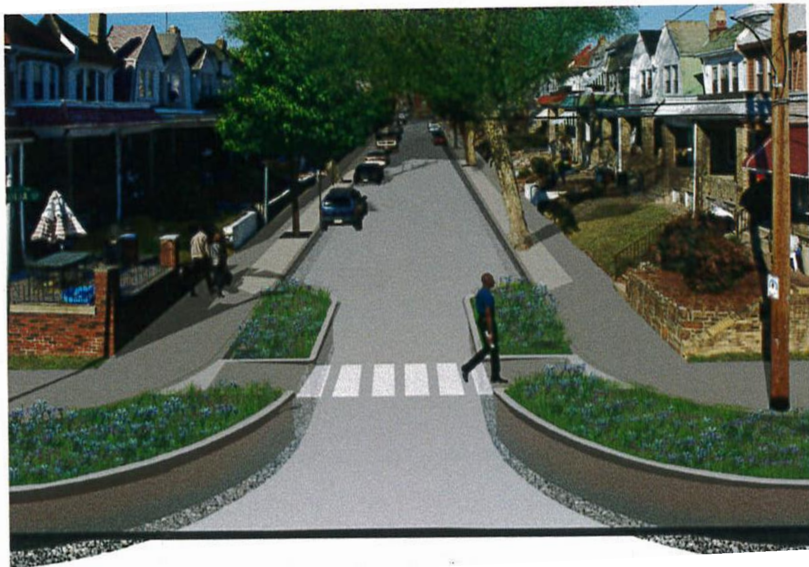
Her er arealet i lavbrekk i tilknytning benyttet til gatekryss og anlagt utstikkende regnbed i gata på hver side av fotgjengerovergangen.
