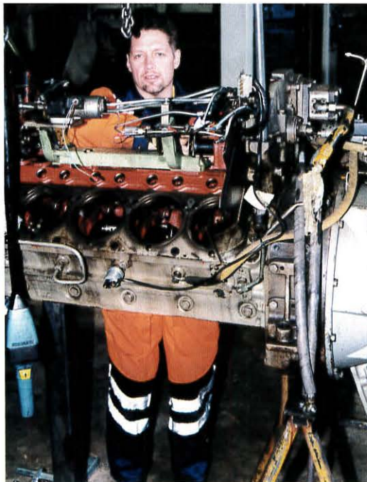
En havareert snøfresermotor bygges opp igjen av Ola Bremhøvd
