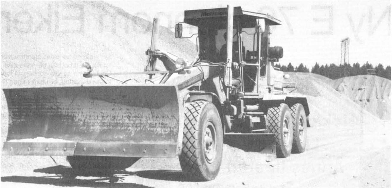
Planering med veghøvelen. – Fagprøve i Stengelsrud grustak.
