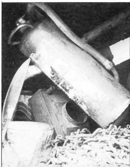
Vi viser her et par eksempler på hvordan det ikke skal være. Til venstre er brannslukningsapparat lagt sammen med mye annet rart. Det er ikke etter forskriftene. Til høyre ser vi en slange som har fått en knekk. Dette er heller ikke så bra.
