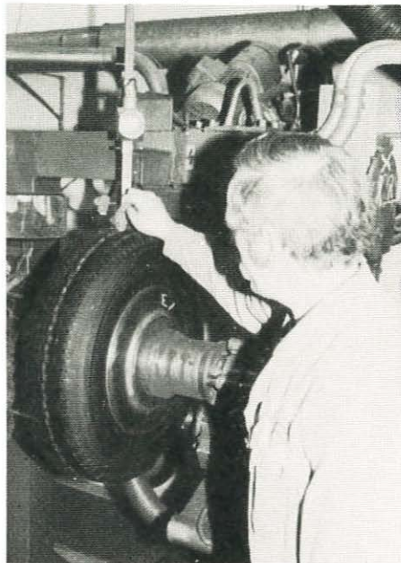
Her blir dekket tilslutt kontrollert, og merket før det er klar for salg.
