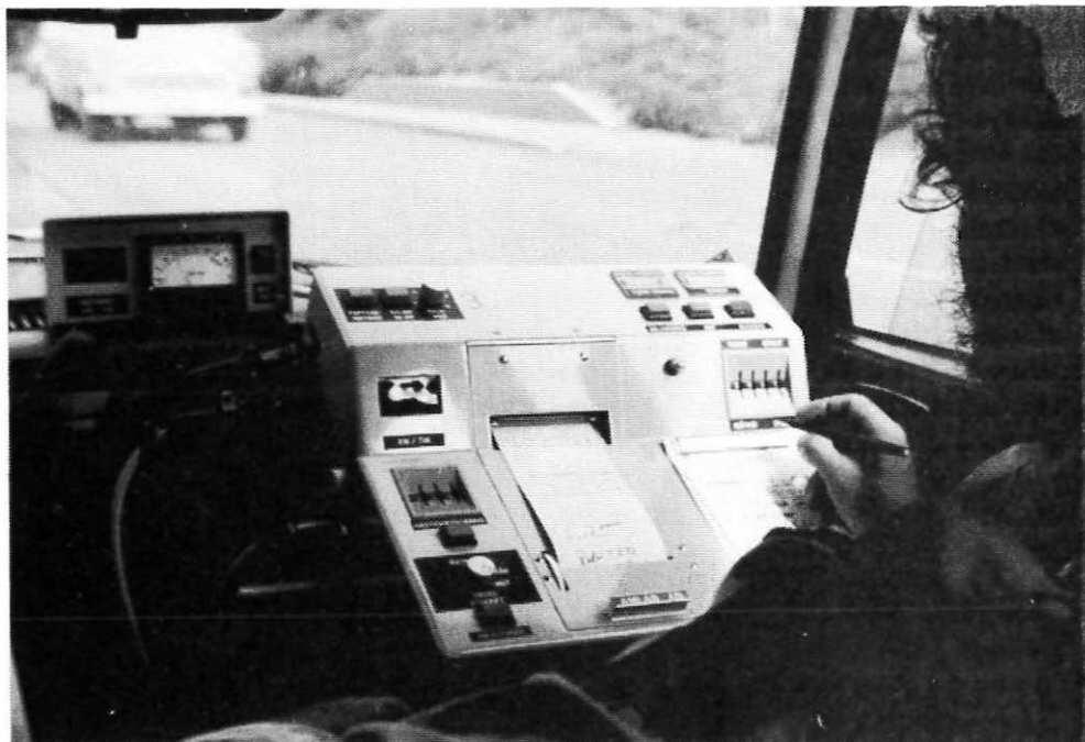
Radarens skrivebel registrerer hastighet og klokkeslett.
