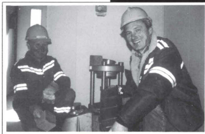
Bildet under: På feltlaboratoriet blir det støpt terninger som testes for trykkfasthet. Gunnar Mo (til venstre) og Trygve Stien.
