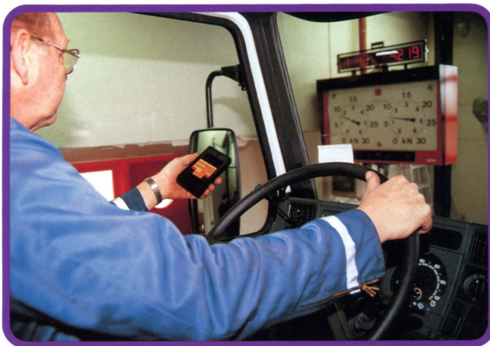
Bremseprøveren fjernstyres trådløst fra førerhuset.
