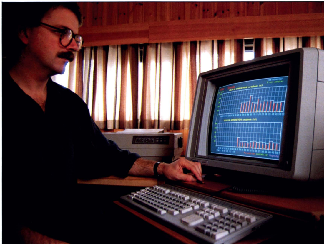
Avd.ing. Rune Lundquist i overvåkningsrommet på vegstasjonen på Ås. Herfra styres variable skiltgrupper ulike steder i fylket som dirigerer trafikken bort fra E18 når denne er overbelastet.
