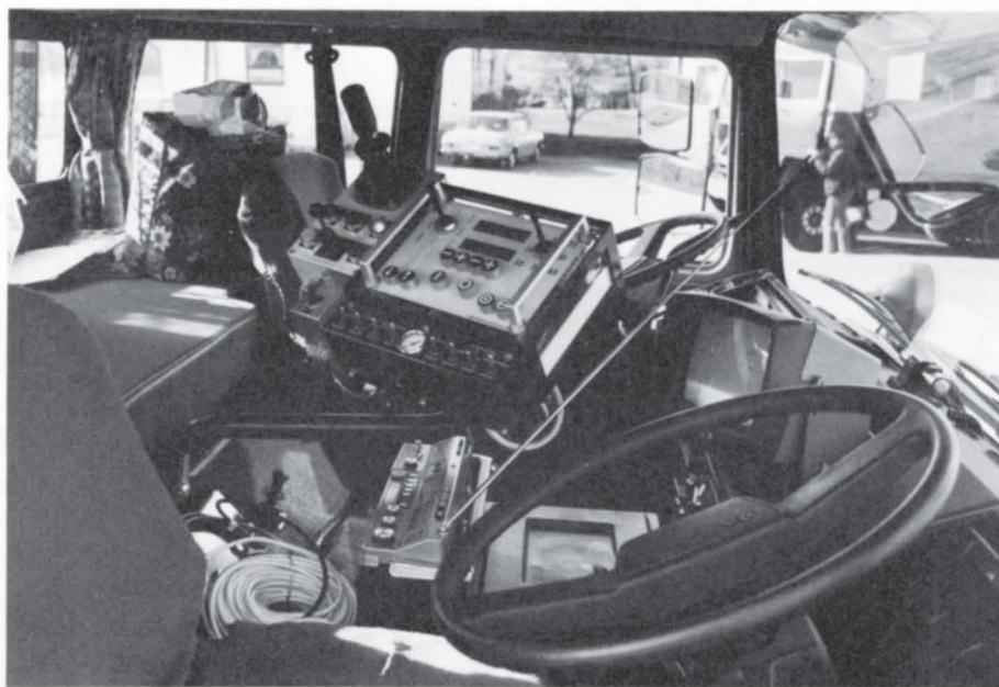
Ved et glimt inn i førerhuset ser vi at bilen er utstyrt med to ratt. Midt i bildet og til høyre mellom rattene sees henholdsvis kontrollpanelet til maleutstyret og TV skjermen som gjør det mulig å følge med på hva som skjer ved malepistolene.
