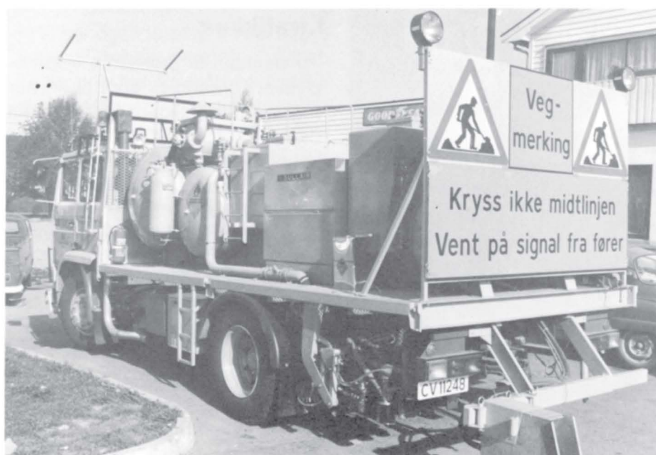
Hele «malerflaket» kan settes av og bilen utstyres med vanlig lasteplan. Dette betyr jo at utnyttelsen på bilen kan bli nærmest optimal.
