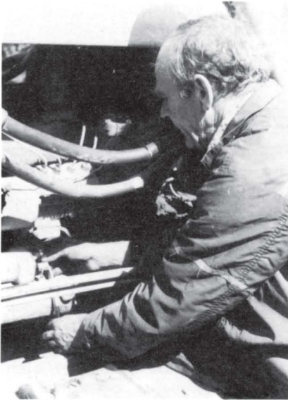
Olav Smørdal i ferd med å montere ny starter i en bulldozer på Lønnskollen.
