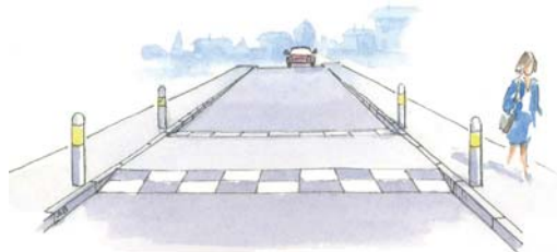
Figur 4.23 Kantmarkering av hump med pullerter
