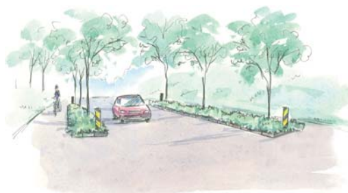
Figur 5.2 Innsnevring fra vegkant
