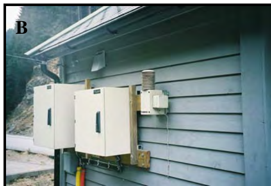
Figur 1. Eksempel på god (A) og dårlig (B) montering av sensorer.
