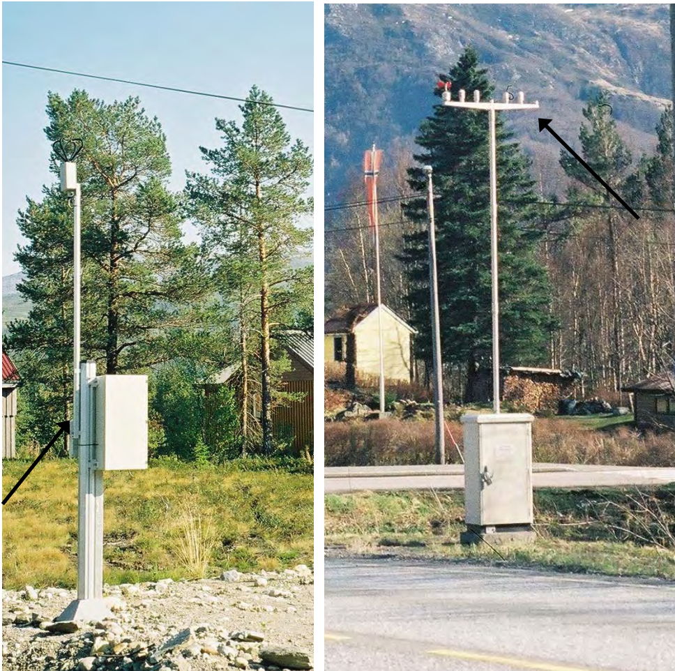
Figur 5. Bilder av en Scan-Matic stasjon (til venstre) og en Aanderaa stasjon (til høyre). Pilen på Aanderaa stasjonen viser den typiske sensorplasseringen for denne stasjonstypen. Pilen på Scan-Matic stasjonen viser lufttemperatursensorenes plassering. Kapittel 3 beskriver anbefalt plassering av sensorer.
