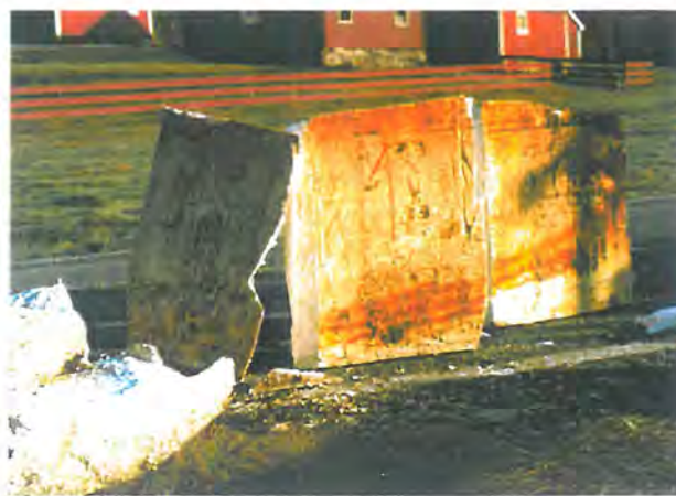
Figur 20. Rv 681 Sande – Osen. Oppgraving av EPS fylling som har ligget neddykket i 9 år.
