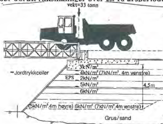
Figur 66. Lastøkning som følge av en spenningsøkning på 6 kPa fra en fullt oppløstet dumper.
