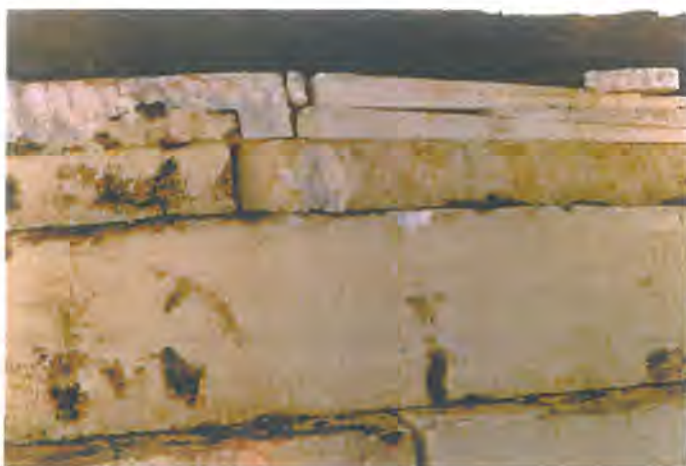
Figur 12. Tvilssom kvalitet av EPS fylling
