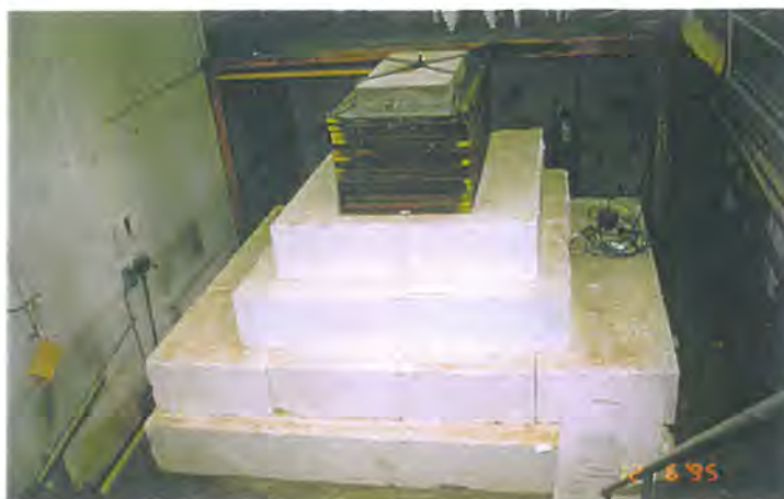
Figur 21. Skalaforsøk med belastning av EPS fylling
