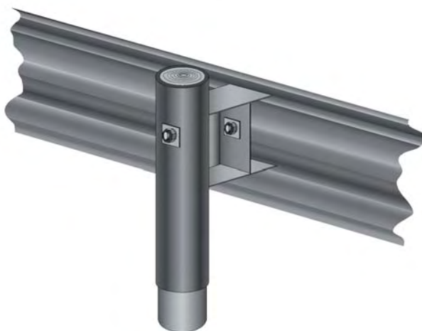
Figur 16. Stålskinne festet til trestolpe med utblokkingsbøyle
