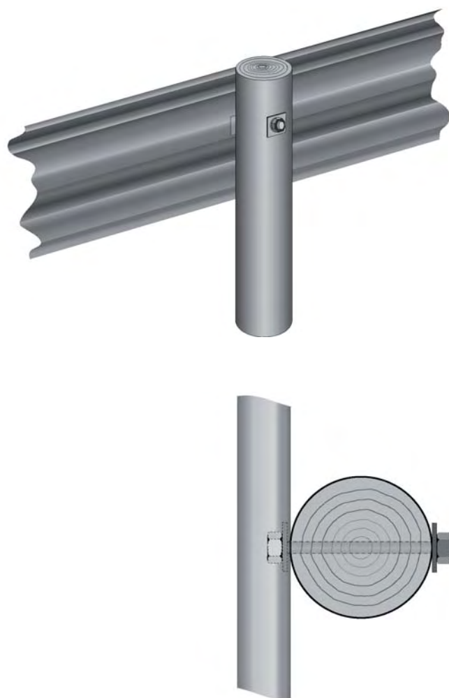
Figur 11. Feste av stålskinne til trestolpe
