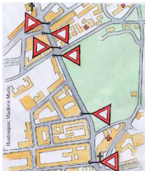
Figur 25 I Ullevålsveien i Oslo har man innført vikeplikt for sidegatene, noe som gir bedre flyt for trafikken i hovedgaten, også bussene.
