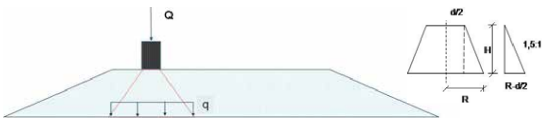
Figur 1-4-17 Trykkfordeling under hjul i vegfylling
