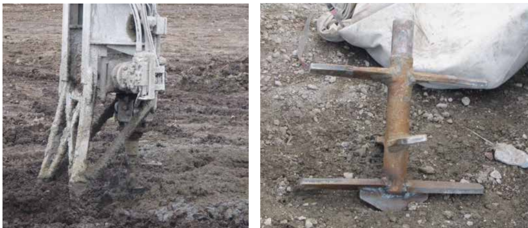
Figur 1-7- 4 Bildet viser fot av tårn og et av innblandingsvertkøyene som finnes på markedet i dag (Foto: Bjørn Kristoffer Dolva).
