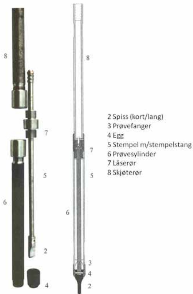
Figur 35 Ramprøvetaker for borrhigg
