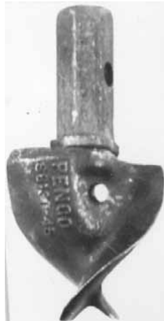
Figur 40 Prisipp og spisser for naverboring ( fingerborspiss og fiskehalespiss)
