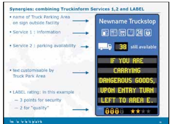
Figur 10 Eksempel på hvordan et opplysningskilt foreslås bygget opp i EU. Hengelåsene antyder sikkerhetsnivå, jo flere låser jo bedre sikkerhet mot kriminalitet (fra prosjektet "SET-POS")
