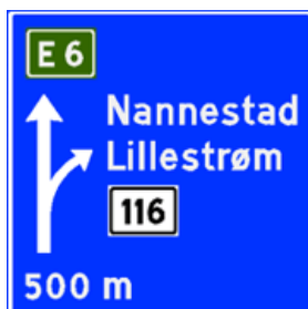
Figur 24: Vegnummer er aktivt i bruk for eksempel på skilt for å vise veifarende hvilken veg de kjører. Europavegnummer vises med vegkategori (grønn bakgrunn), fylkesvegenummer vises kun med vegnummeret (hvit bakgrunn). Kun Primære fylkesvegnummer vises på denne type skilt. Hadde det vært visning til riksveg her ville riksvegnummeret også vært vist med kun vegnummeret, men med grønn bakgrunn.
