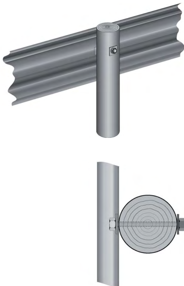
Figur 11. Feste av stålskinne til trestolpe
