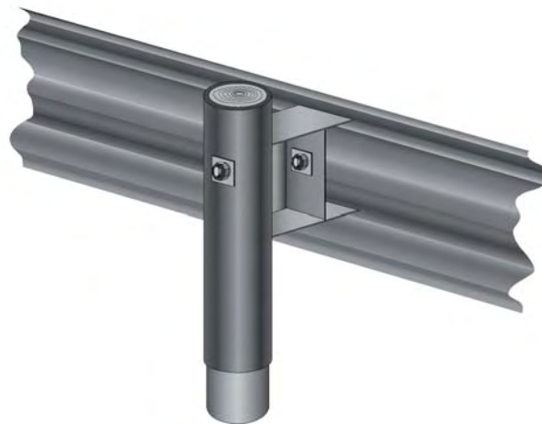
Figur 16. Stålskinne festet til trestolpe med utblokkingsbøyle
