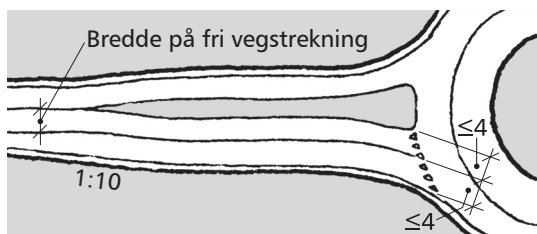
Figur 4.11: Breddeutvidelse fra ett til to kjørefelt på tilfarten (mål i m)
