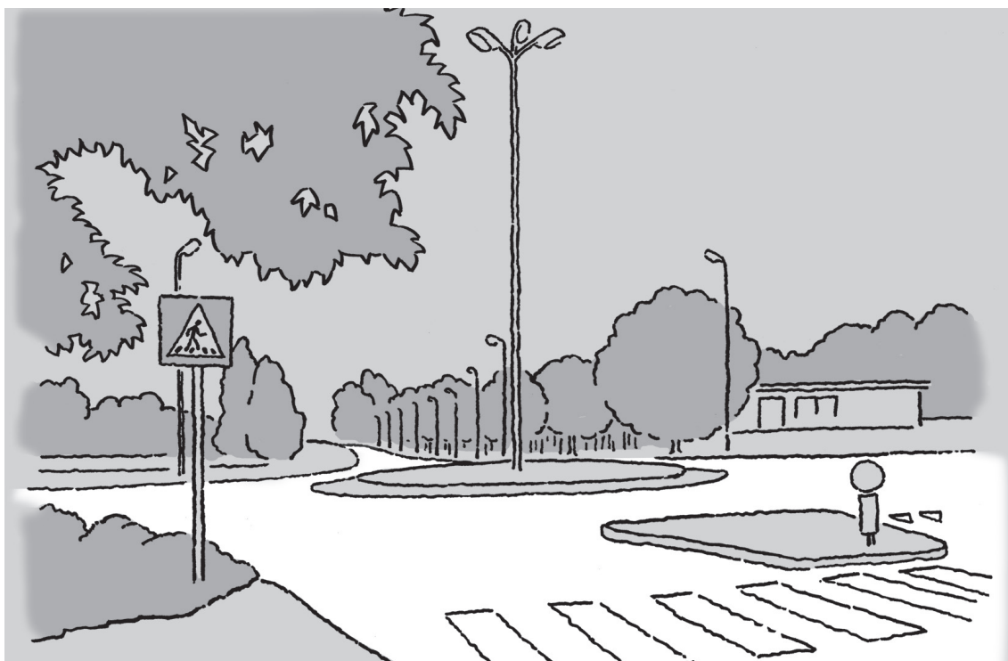
Figur 4.7: Lysmast i sentraløya markerer rundkjøring
