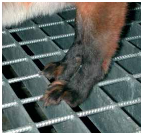
Figur 6-30: Forsøk med rødrev i fangenskap har vist at gitterrister med åpninger på 70x90 mm har en avvisningseffekt. (Foto: B. Iuell)
