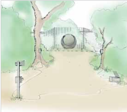
Figur 7-7: Faunapassasje med fotoapparat. Når dyr bruker passasjen, bryter de en infrarød stråle som aktiverer et digitalt kamera. Dette gjør det lett å undersøke bruk av passasjen.
