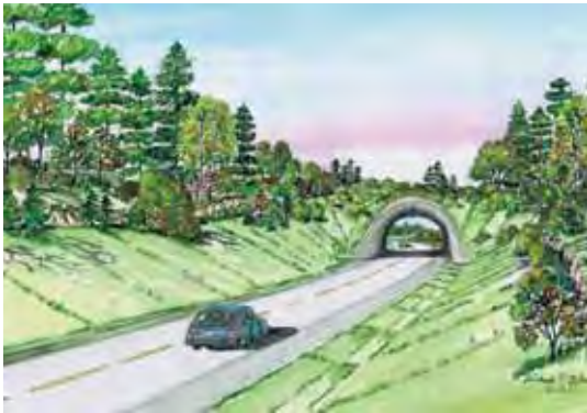
Figur 3-3: Eksempel på avbøtende tiltak. Planlagt (venstre) og ferdig (høyre) faunapassasje på ny rv 35 mellom Roa og Gardermoen. Fotoet av overgangen ble tatt like etter ferdigstilling, og lite vegetasjon var foreløpig etablert. (Illustrasjon og foto: W. Hollum)
