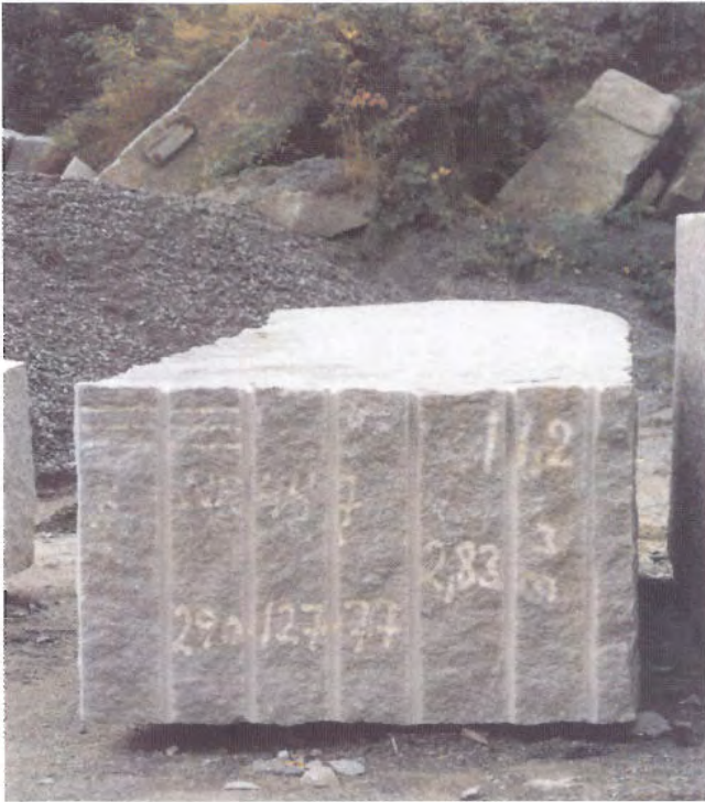
Råkilt overflate, naturplan med merker etter utstyret som ble brukt under kløyvingen. Gjennomgående borhull tyder på dårlig utviklede kløvretninger. Fra Åros bru. Foto: Per Eikemo/Hilmar Selseng
