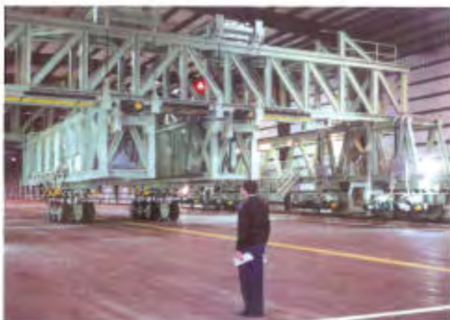
Figur V3.8 Fullskalaforsøk, dimensjonering for framtidige flytyper (Luftfartsverket)
