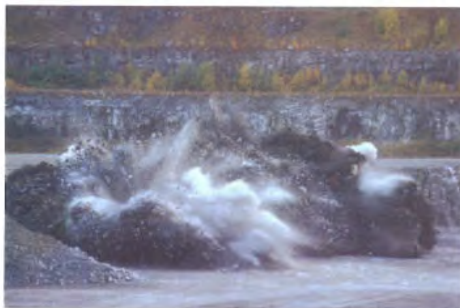
Figur 4.8 Lite vellykket salve, sprengningsenergien resulterer i sprut (Dyno)
