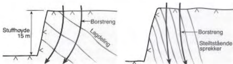
Figur 4.9 Mulige konsekvenser ved boring i lagdelt fjell
