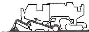
Figur 3.10 Eksempel på utstyr for kald resirkulering på veg.
