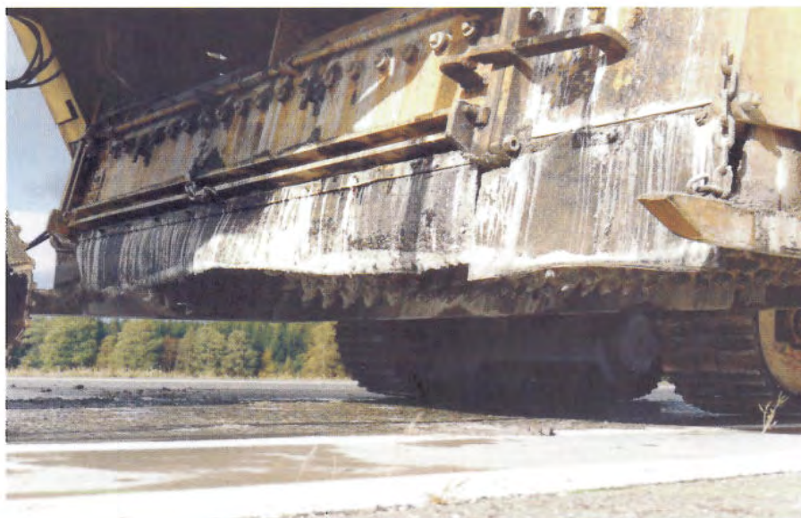
Figur 11.1 Trommelen på en piggvalsefres
