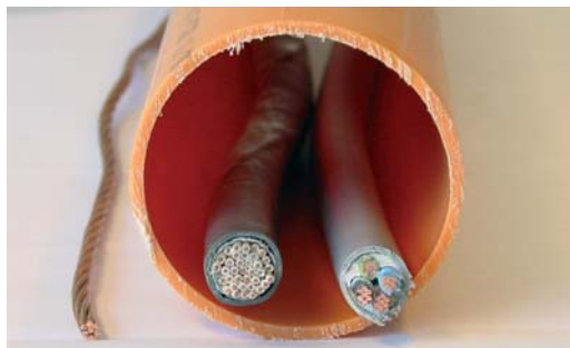
Figur 2-56: Signalkabel (PFSP 37 \times 1,5 \text{ mm}^2 ) og strømkabel (PFSP 3 \times 16 \text{ mm}^2 ) i 110 mm rør med jordingskabel ( 25 \text{ mm}^2 blank KGE) på utsiden av røret.
