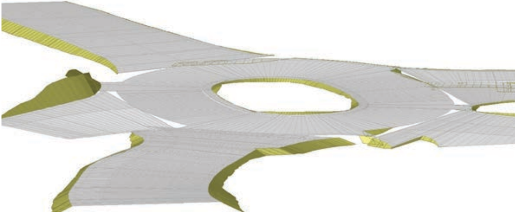
Figur 12: Fagmodell veg. Delmodellen viser triangulert vegoverflate og skråningsutslag uten teksturer
