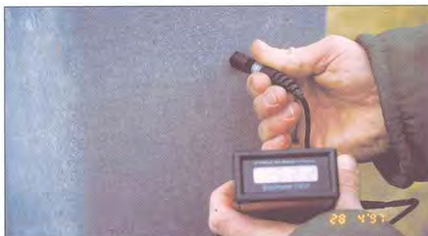
Figur 7.7-2 Tykkelse av overflatebelegg på stål
