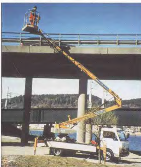
Figur 4.2-3 Liten kurvlift montert på lastebil
