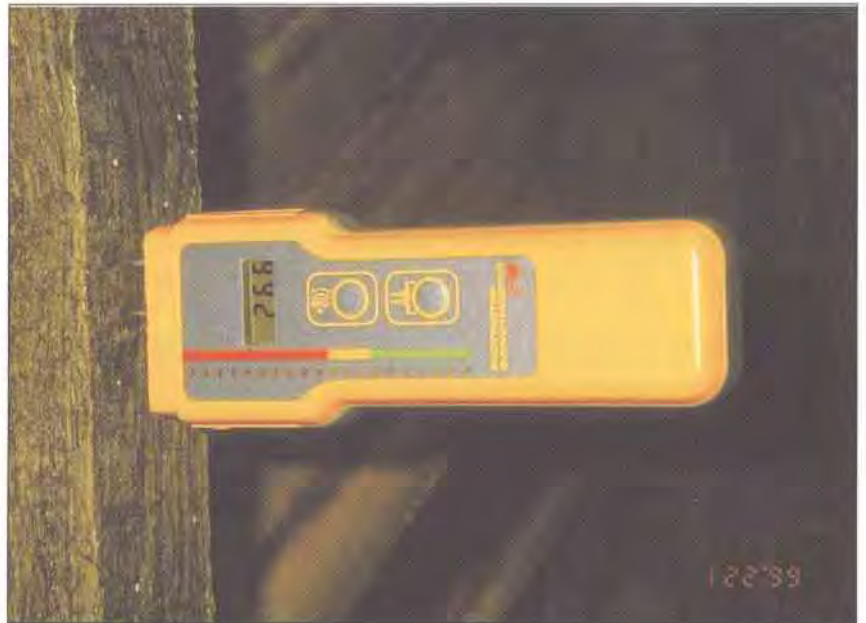
Figur 7.5-1 Fuktmåling på tre
