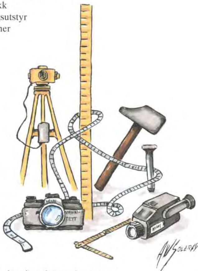
Figur 4.1-6 Utstyr hovedinspeksjon under vann
