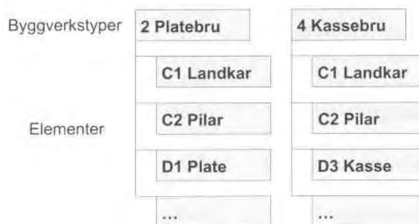
Figur 2.1-1 Byggverkstyper og elementer
