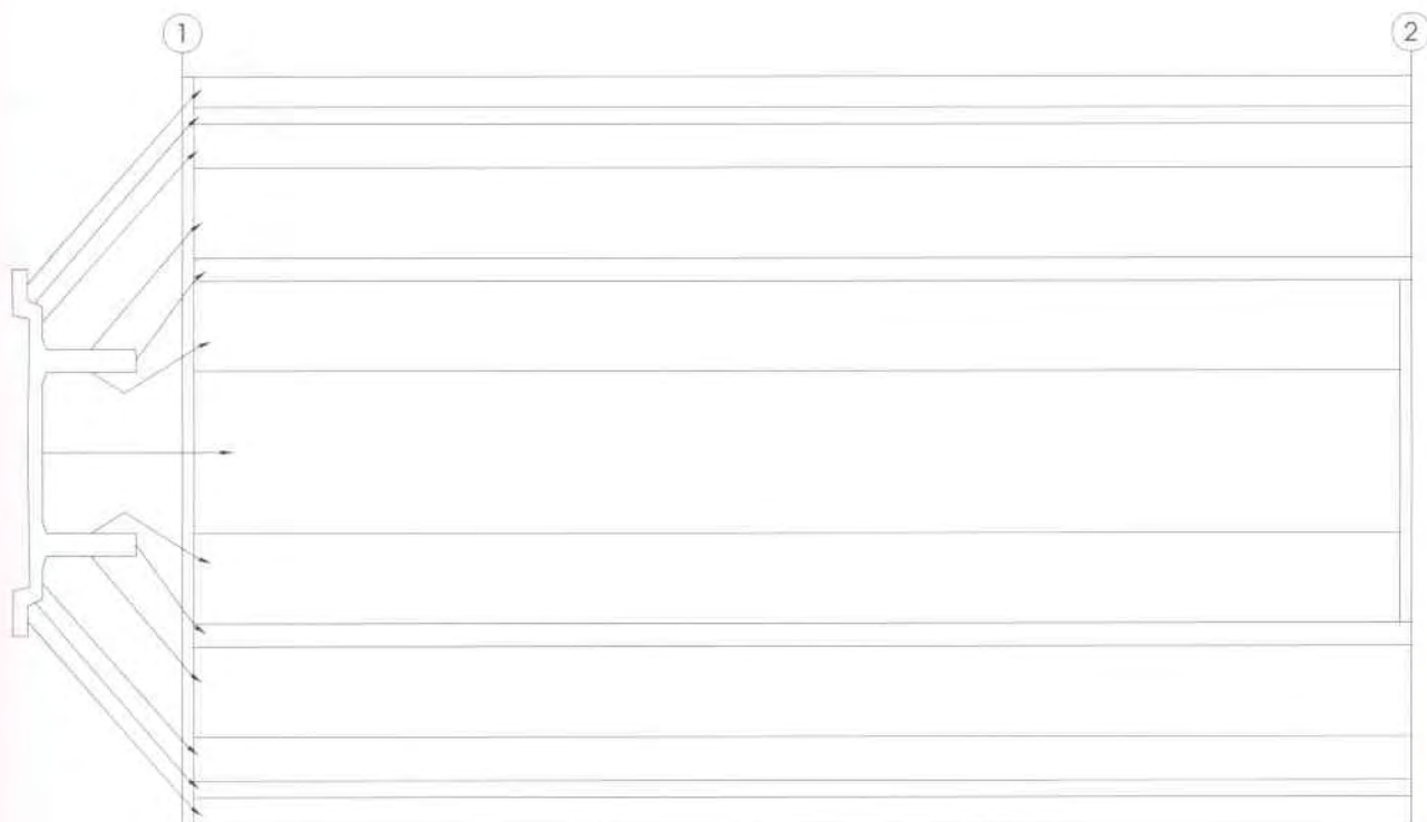
Figur 2.4-8 Eksempel på utbretting av bjelkebru
