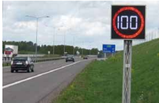
Figur 2.2 Eksempel på lysende billedpunktstilt.
