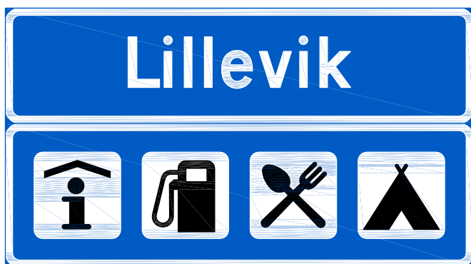
Figur 5-3.13 Utforming av serviceskilt under stedsnavnskilt
